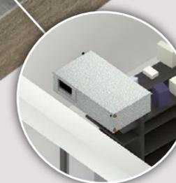
Climatiseur monobloc horizontal à condensation par eau
